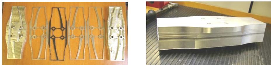
*Bild 15: Einzelne Lagen der Bauteile vor dem Diffusionsschweißen und fertig gefügtes Bauteil*
