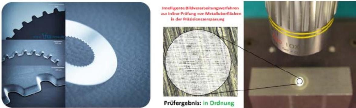
Bild 1: Schnelle automatische Inline-Oberflächenbewertung
