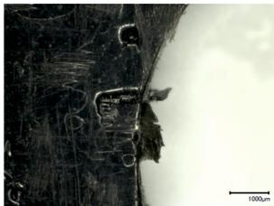
Bild 3: Push-out Delamination der Bohreraustrittsseite von Bohrung 63 mit überlagerten Ultraschallschwingung. Delaminationen treten vor allem dann auf, wenn die Faserrichtung nicht der Schnittrichtung entspricht (Faserschnittwinkel =  $90^\circ$ ).
