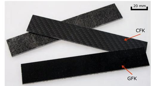
Bild 1: Glas- und Kohlenstofffaserverstärkte Kunststoffprobeplatten (GFK und CFK)
